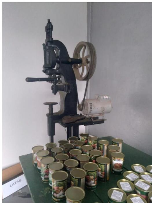
**Figura 8 - Máquina manual seladora de latas.**
