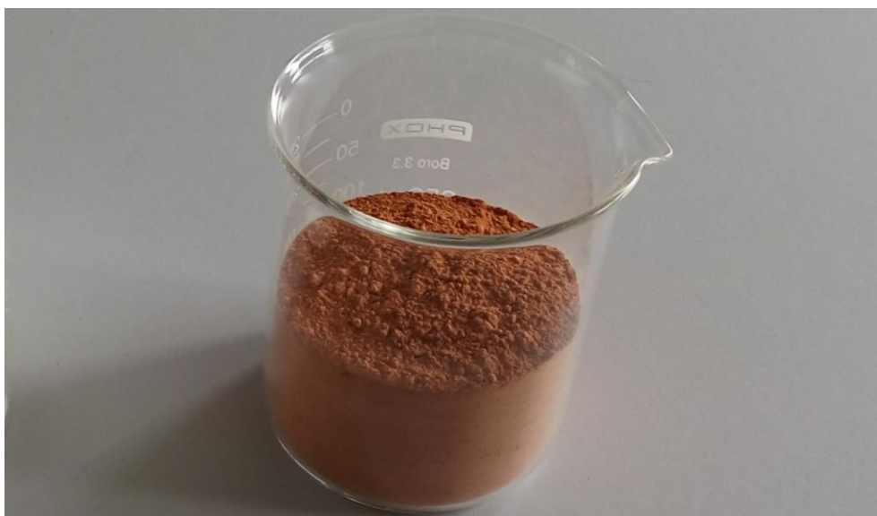
Figura 1: Resíduo beneficiado de telha cerâmica vermelha. Fonte: elaborado pelos autores.
