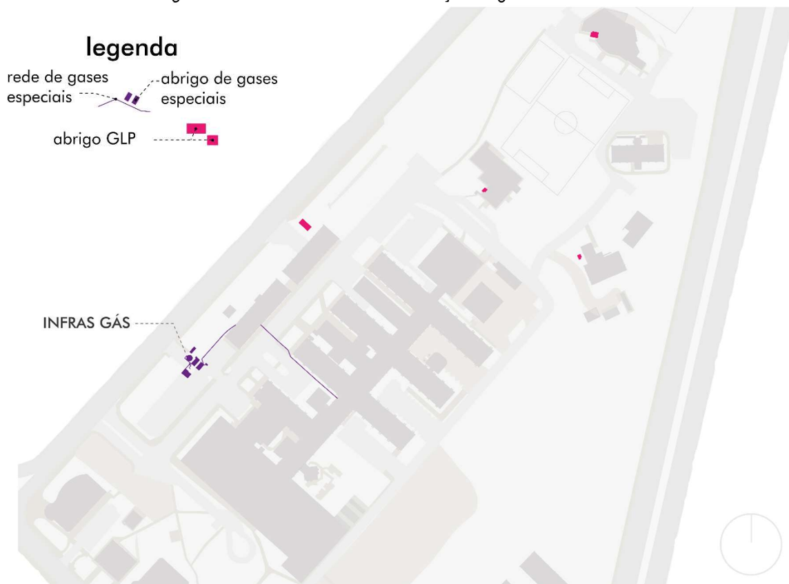
Figura 33 – Armazenamento e distribuição de gases na área de estudo
