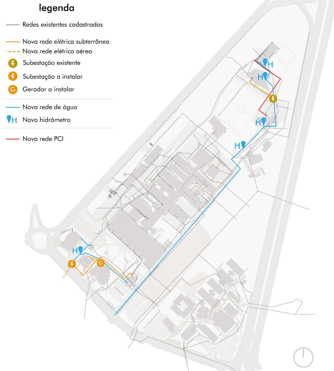
Figura 58 – Disposição final das redes de infraestrutura com as alterações propostas
