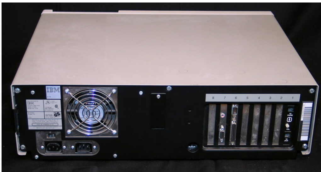
Figura 9 – Porta RS-232 no IBM PC AT.
