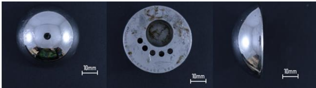
Figura 38 - Registro fotográfico amostra 3 – cabeça umeral região convexa, côncava e lateral.
