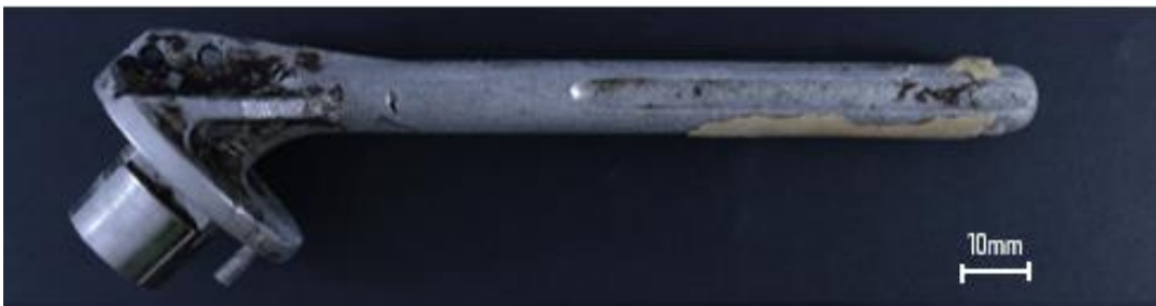
Figura 39 - Registro fotográfico amostra 3 – haste umeral região anterior
