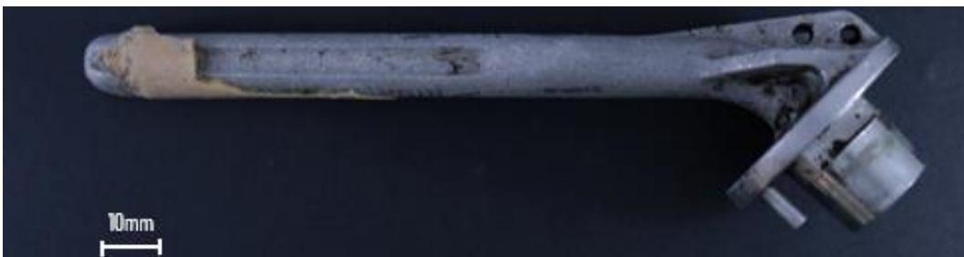
Figura 40 - Registro fotográfico amostra 3 – haste umeral região posterior
