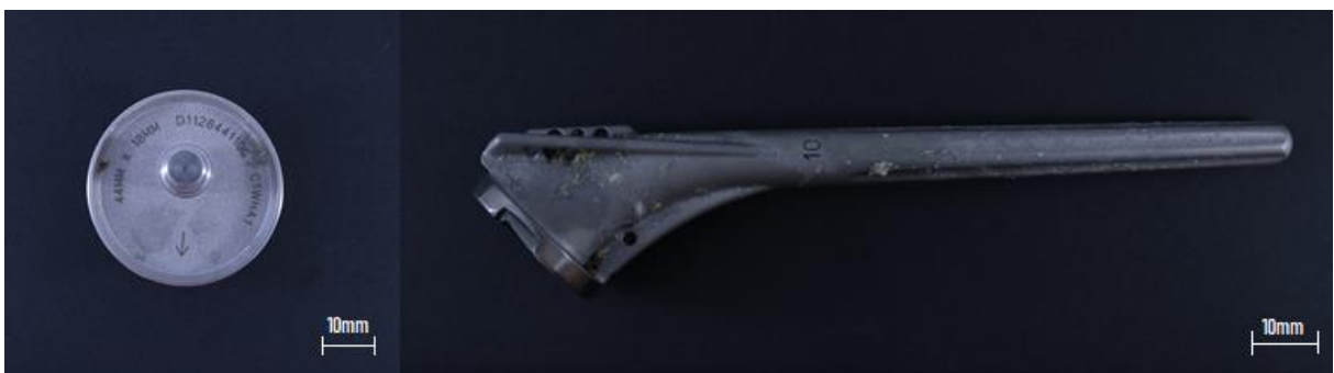
Figura 14 – Componentes da AMOSTRA 1: Prótese anatômica de artroplastia parcial de ombro (hemiartroplastia com haste) – modelo de haste de conicidade fêmea.
