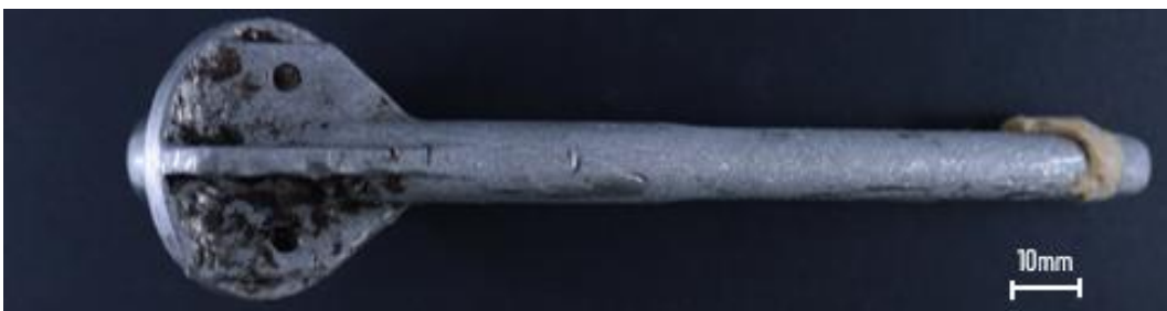
Figura 41 - Registro fotográfico amostra 3 – haste umeral região lateral
