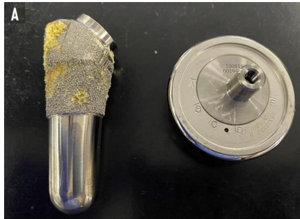
Figura 9 – Exemplo de amostra de prótese de ombro anatômica analisada – haste umeral de titânio e cabeça umeral de CoCr. Fonte: (BRUSALIS et al., 2022).
