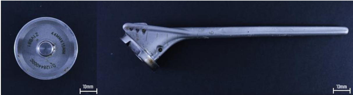
Figura 15 - Componentes da AMOSTRA 2: Prótese anatômica de artroplastia parcial de ombro (hemiartroplastia com haste) – modelo de haste de conicidade fêmea.
