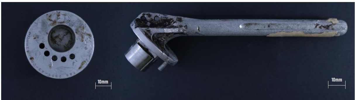
Figura 16 - Componentes da AMOSTRA 3: Prótese anatômica de artroplastia parcial de ombro (hemiartroplastia com haste) – modelo de haste de conicidade macho.
