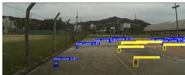
Figura 1 – Detecção de Cones - Projeto do Lapix
