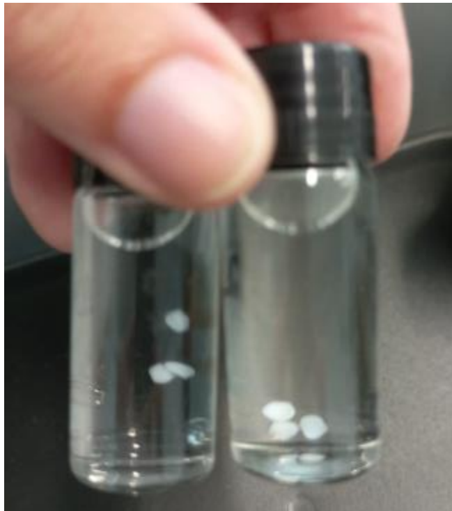
Figura 14 - Mudança visual dos beads após ser condicionado ao meio com pH 0,9 após 2 horas.
