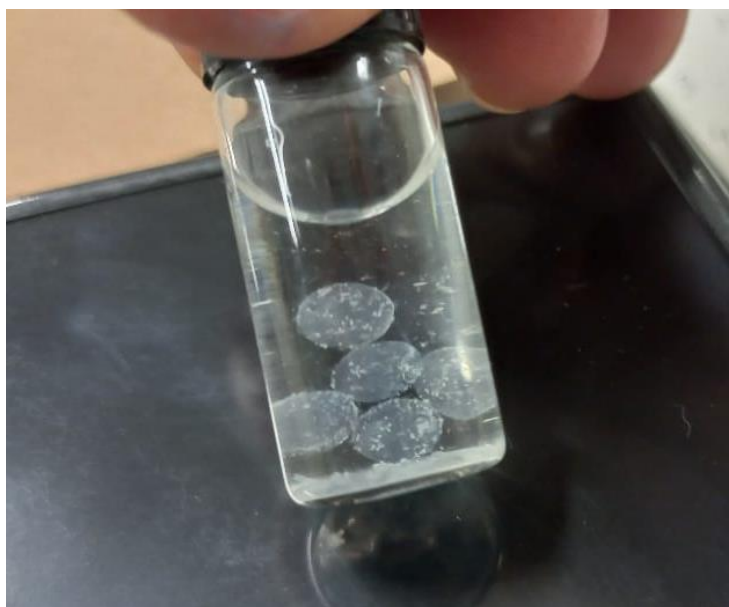
Figura 15 - Mudança visual dos beads após ser condicionado ao meio com pH 6,6 após 2 horas.
