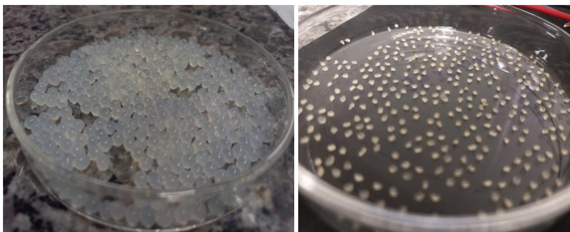
Figura 9 - Hidrogéis distribuídos em placa petri para secagem. A imagem da esquerda antes de secagem e imagem à direita, após a secagem.
