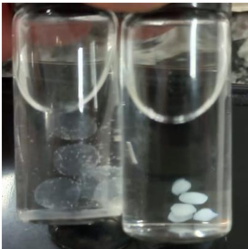
Figura 16 - Aparente reações dos beads nos meios SIF (esquerda) e SGF (direita)
