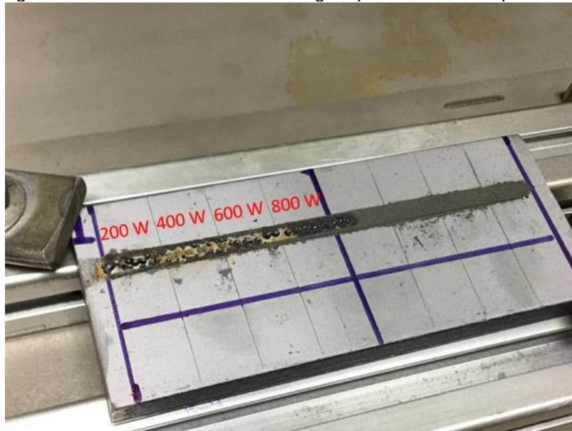
Figura 19: Resultado do laser cladding no primeiro ensaios preliminar
