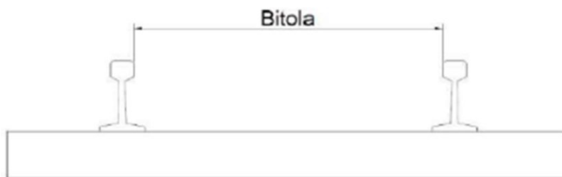
Figura 8. Ilustração da bitola como sendo a distância entre os trilhos paralelos
