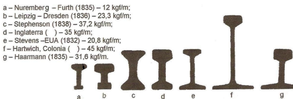
Figura 4 - Evolução do Perfil dos Trilhos – Perfis com capacidade de carga para “apoios isolados”
