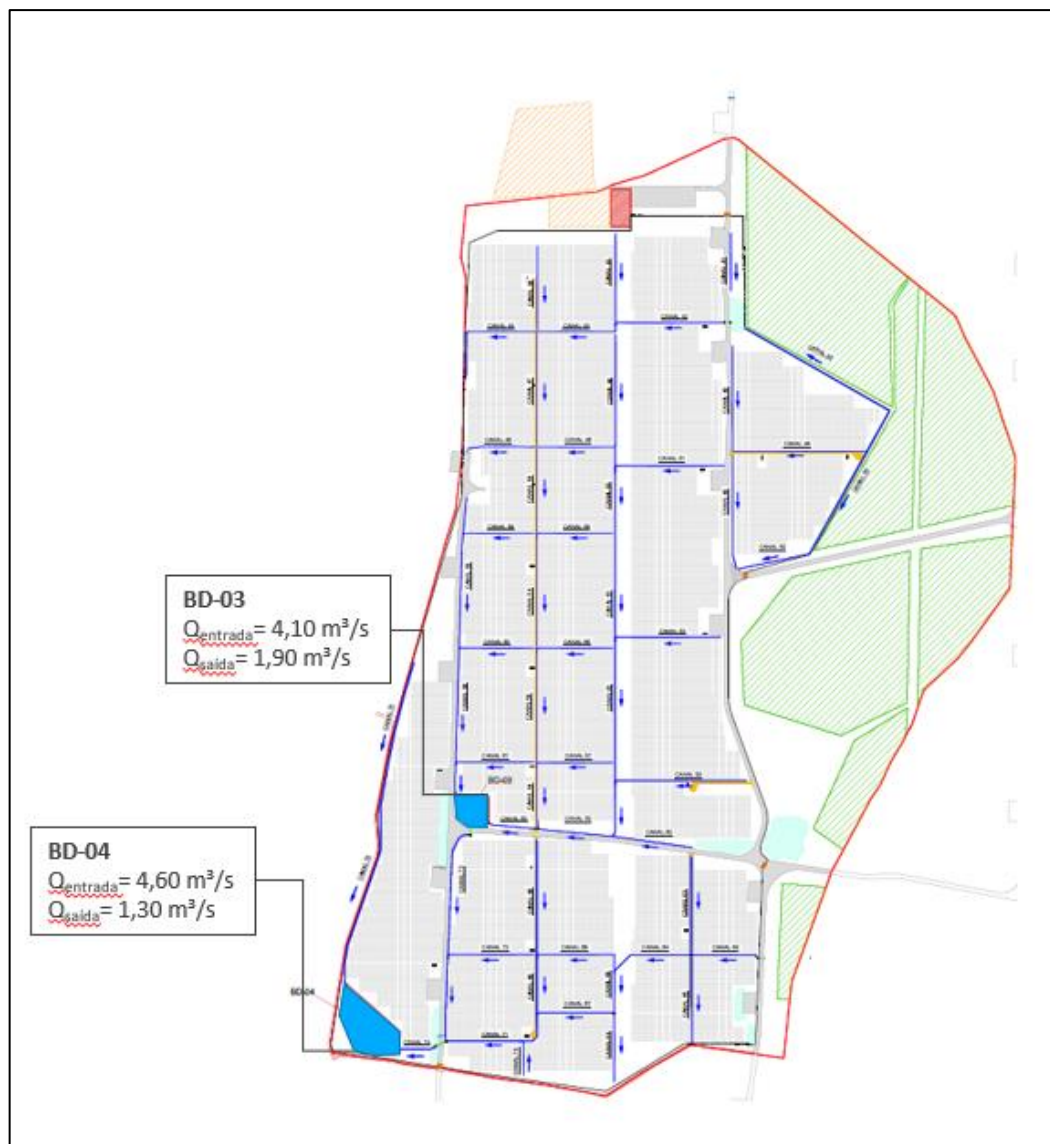
Figura 21 - Sistema de drenagem proposto.
