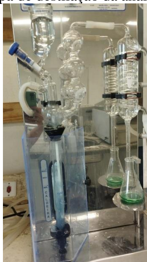
Figura 10 – Etapa de destilação da análise de nitrogênio.
