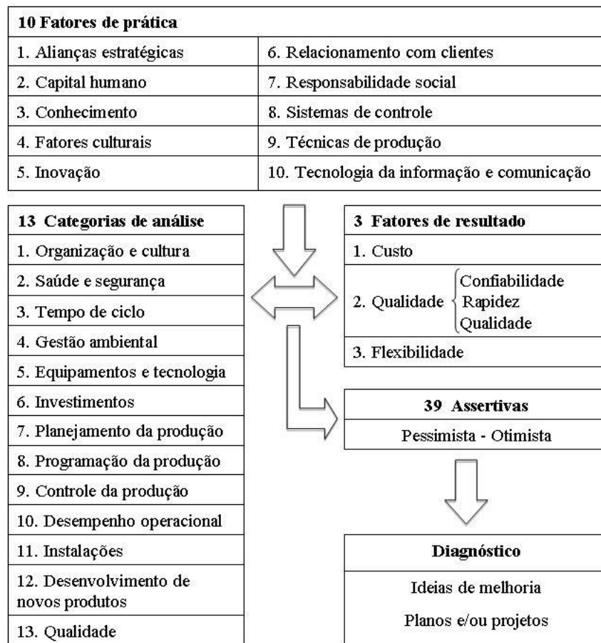
Figura 2 - Componentes do instrumento de avaliação de sistemas de produção e sua lógica de aplicação
