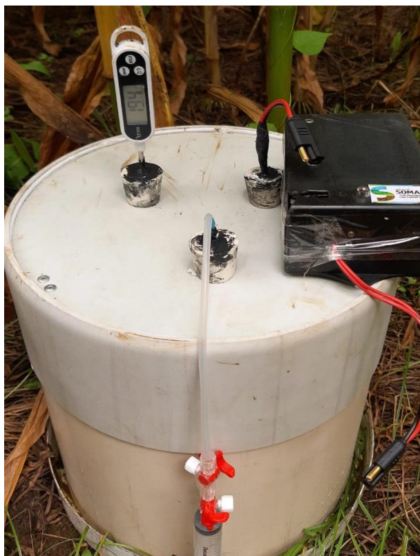
Figura 2 – Câmara para coleta de N_2O , contendo termômetro, bateria e seringa.
