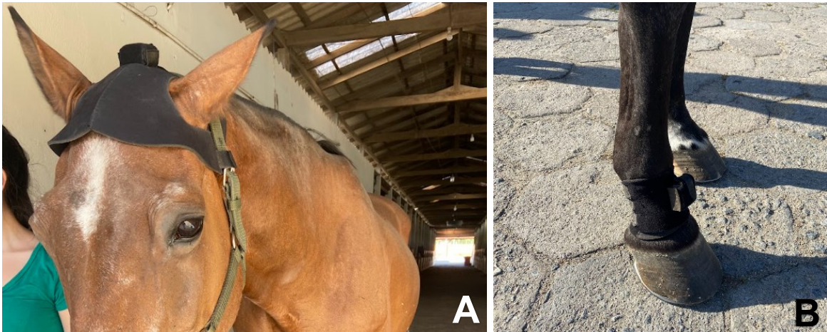
Figura 9 – Posicionamento dos sensores inerciais na região da cabeça (A) e membro torácico direito (B).
