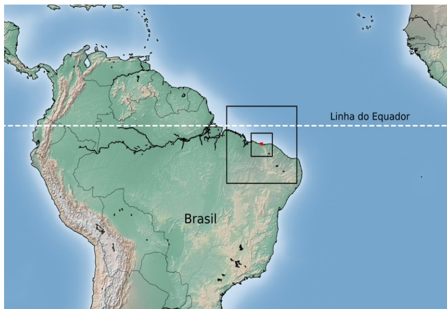
Figura 18 – Localização do Parque Eólico de Pedra do Sal e domínios da grade computacional D1 (externo) e D2 (interno) aninhados do modelo de mesoescala.
