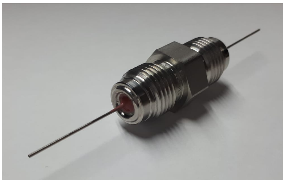
Figura 4.6 – Novo microcanal (Mc4) fabricado a partir de uma conexão VCR
