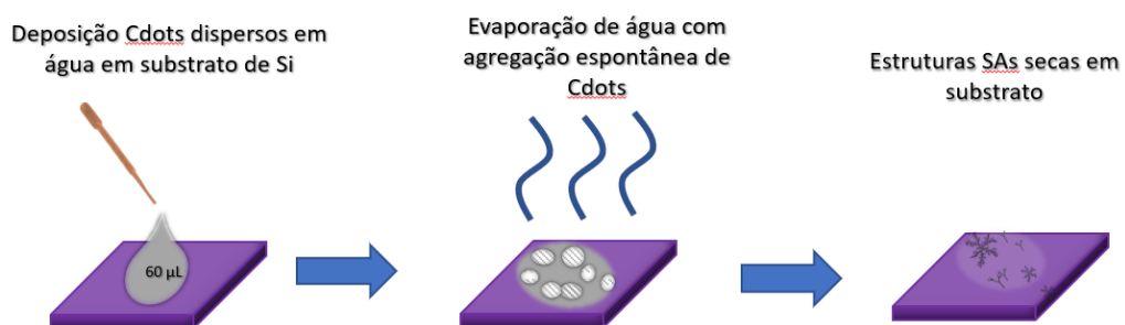
Figura 18: representação do processo de deposição de solução e formação de estruturas auto-organizadas.
