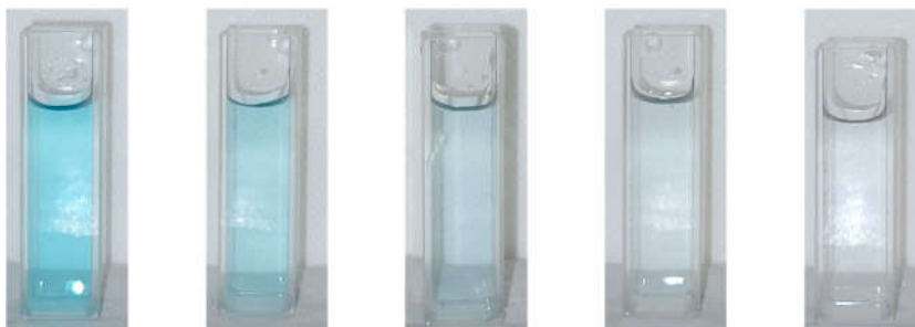
Figura 26 – Amostras do azul de metileno durante a fotocatalise nos tempos 0, 15, 30, 45 e 60 minutos, na configuração SSN
