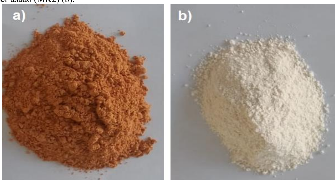
Figura 48. Aspecto visual do metacaulim inicialmente usado (MK1) (a) e do novo metacaulim a ser usado (MK2) (b).
