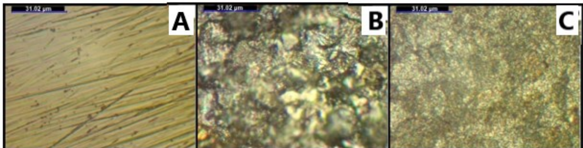
Figura 12 - Micrografias ópticas (400x) do aço: A) polido; após 12 horas de imersão em \text{H}_2\text{SO}_4 0,5 \text{ mol L}^{-1} B) na ausência e C) na presença de HSSE 1233,4 \text{ mg L}^{-1} .
