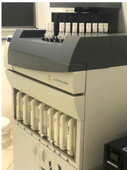
Equipamento VENTANA - modelo Benchmark XT, para realização de imuno-histoquímica semiautomatizada. Fonte: o Autor.
