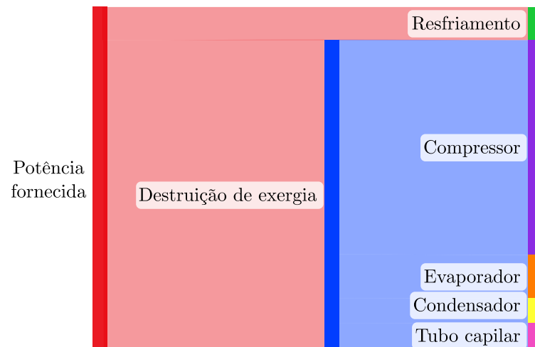
Figura 1.1 – Distribuição das perdas termodinâmicas a partir da distribuição do fluxo de exergia em diagrama Sankey. Adaptada de Jakobsen (1995)
