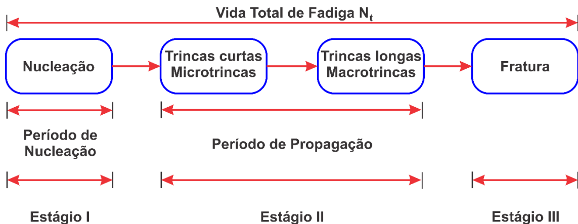
Figura 12 - Esquema mostrando o período de vida total de fadiga.
