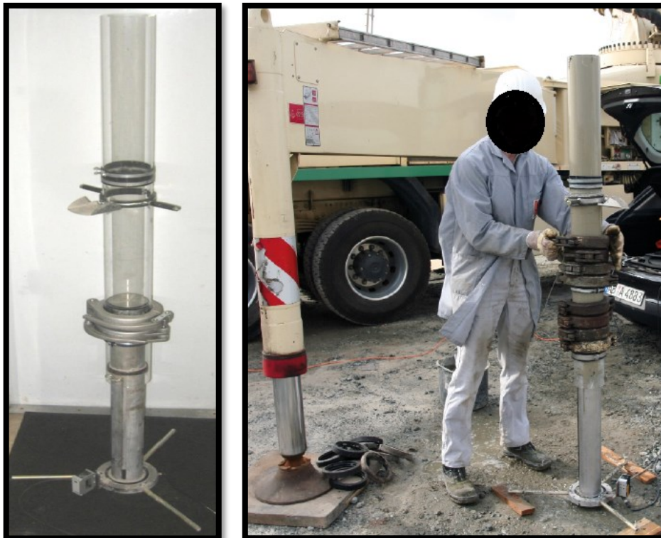
Figura 12 – Reômetro de tubo deslizante - Sliper
