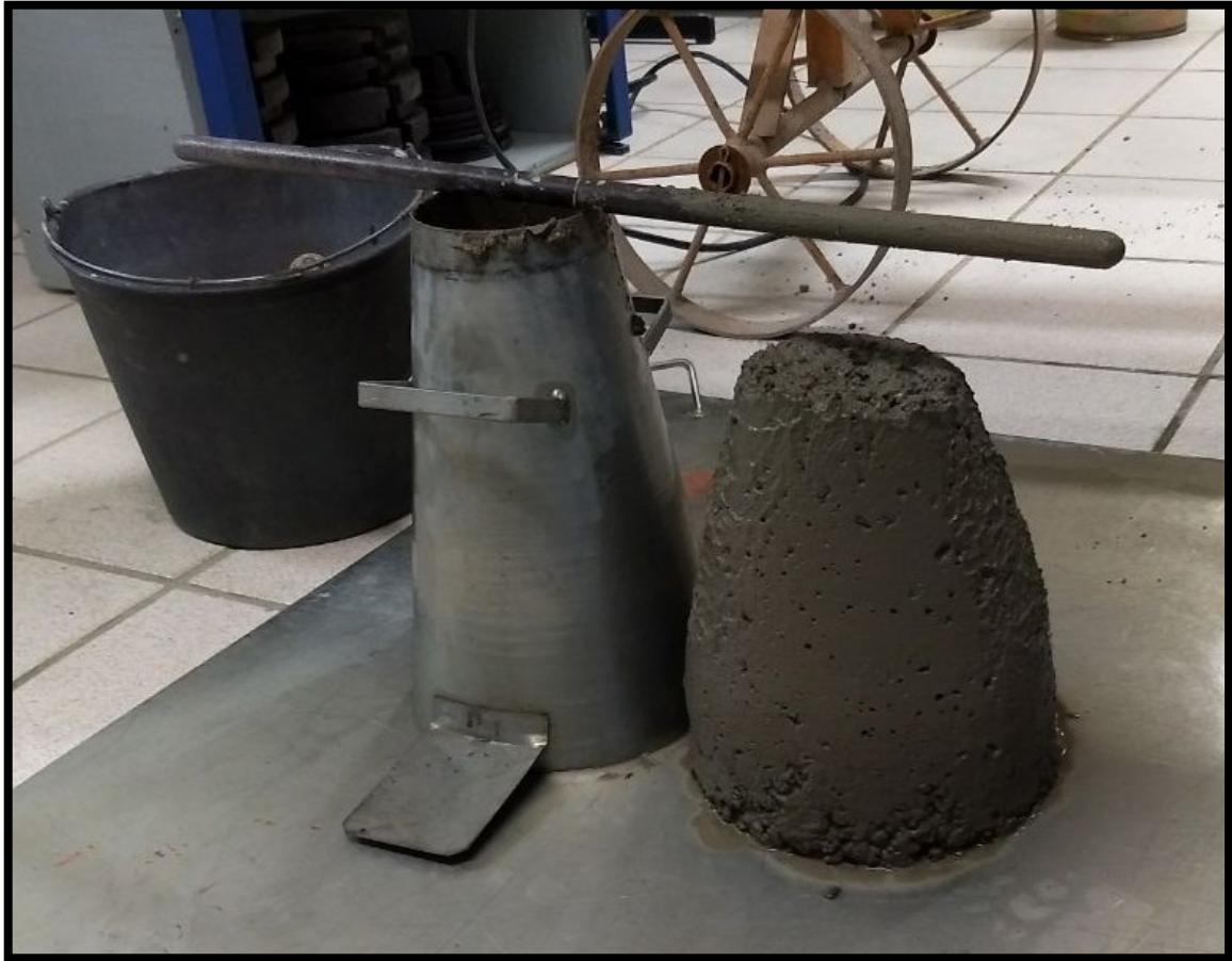
Figura 4 – Abatimento de tronco de cone de Abrams
