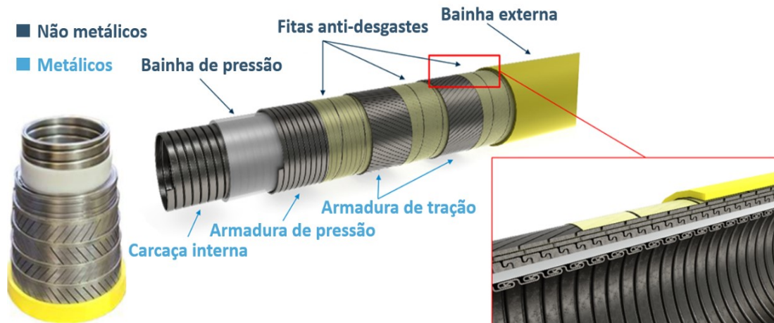
Figura 7 – Camadas Externas e Internas do Riser
