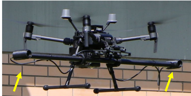
Figura 23 - Sistema estéreo embarcado no RPAS DJI M210 v2. Câmeras indicadas por setas em amarelo.
