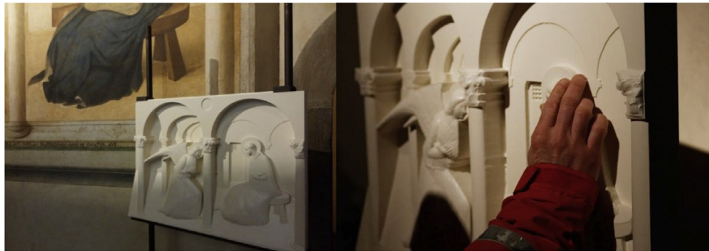
Figura 20 – Modelo tátil de “Anunciação” de Beato Angelico desenvolvido por fresagem CNC
