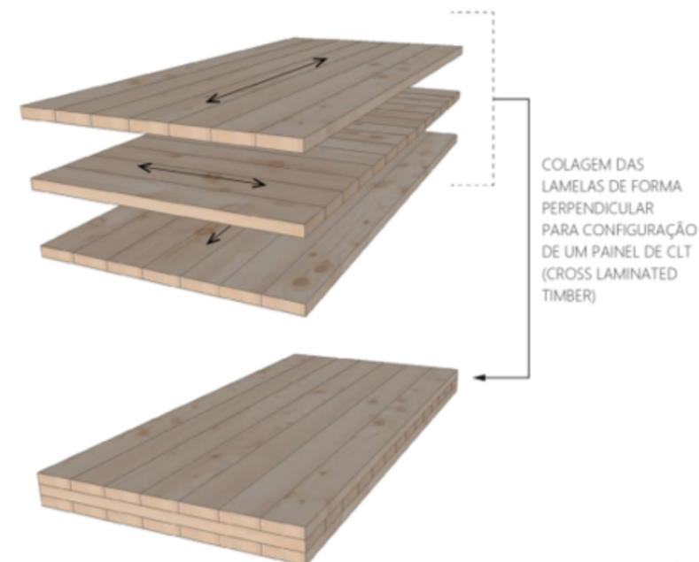
**Figura 1: Representação de painel CLT. Fonte: Oliveira (2018).**
