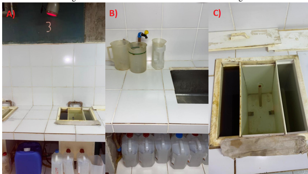
Figura 9 - A) Bancada com tanques de processamento radiográfico; B) Acúmulo de resíduos para descarte; C) Tanque de processamento com as três divisórias – revelador, água, fixador
