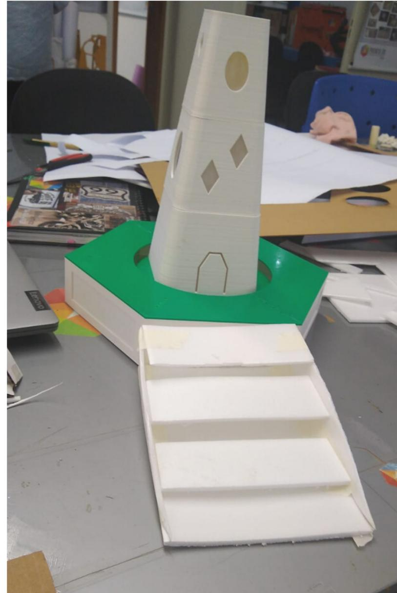
O mockup da escada foi produzido com isopor e fita crepe, sendo realizado durante a matéria de materialização, com o objetivo de confirmar as dimensões para posteriormente ser feito o corte com o material definitivo.
