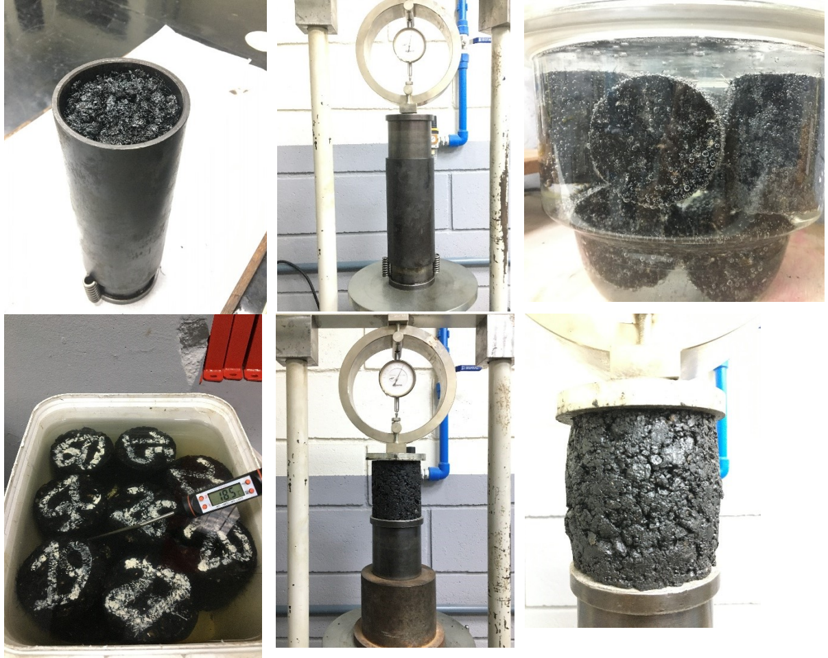
Figura 4.17 - Sequência do ensaio de Duriez: (a) Amostra no cilindro de compactação, (b) Compactação por duplo pistão, (c) Saturação das amostras, (d) Acondicionamento em água, (e) Compressão uniaxial na prensa, (e) Corpo de prova após o ensaio de compressão uniaxial.
