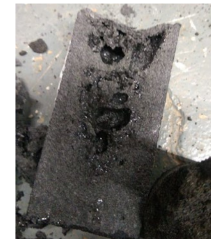
Figura 02: CP com vazios. Fonte: Autoria própria (2022).
