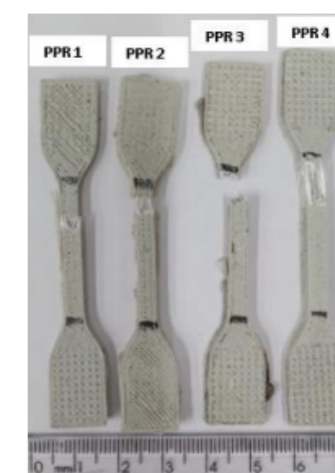
Figura 7 - Corpos de prova de PP reciclado após ensaio de tração. Fonte: Autores.
