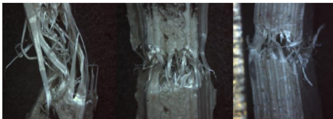
Figura 5: Corpos de prova PPR 4 e PPR1 rompidos. Fonte: Autores.
