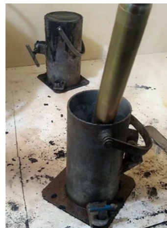
Figura 04: Vibrando o compósito. Fonte: Autoria própria (2022).
