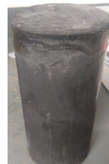
Figura 05: Corpo de prova 10x 20 cm- vazios. Fonte: Autoria própria (2022).
