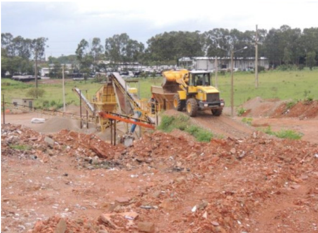
Figura 03 – Transporte dos resíduos para o alimentador com a pá carregadeira
