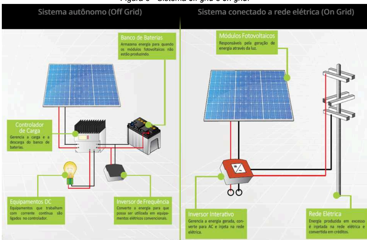
Figura 6 - Sistema off grid e on grid .
