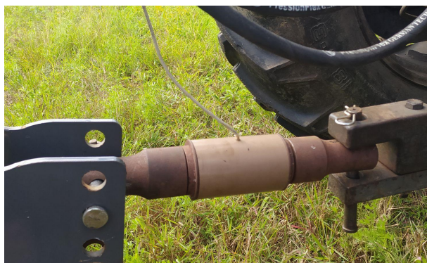
Figura 2. Célula de carga entre a barra de tração do trator e o engate do cabeçalho da semeadora-adubadora. Florianópolis, 2022
