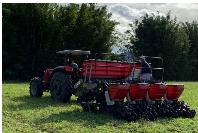
Figura 1. Conjunto semeadora-adubadora. Trator Massey Ferguson modelo 4291 Xtra e semeadora Massey Ferguson modelo MF 508. Florianópolis, 2022
