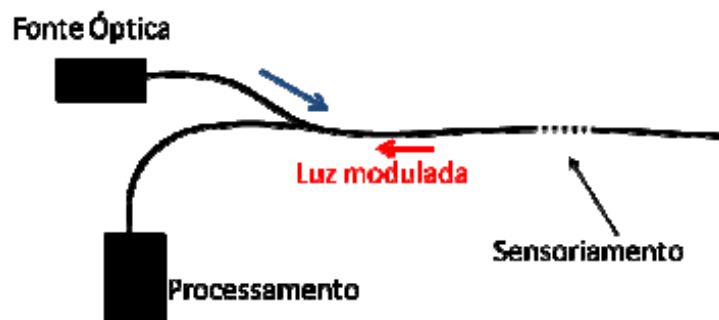
Figura 9 – Esquema de sensoriamento de um sensor intrínseco.
