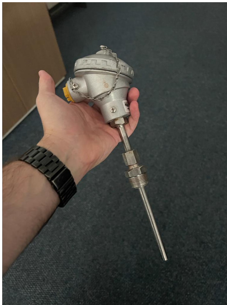
Figura 22 – Sensor PT100 usado em transformadores.
