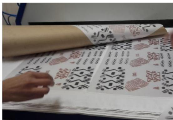
**Figura 4: Processo de transferência por sublimação em tecido. Fonte: Elaborado pelos autores.**
