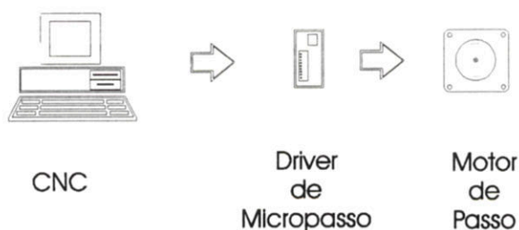
Figura 4.1. - CNC e o Sistema de Acionamento
