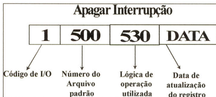
figura 7.6 - Cabeçalho do arquivo padrão tipo 500 com lógica para apagar uma interrupção no FI2
