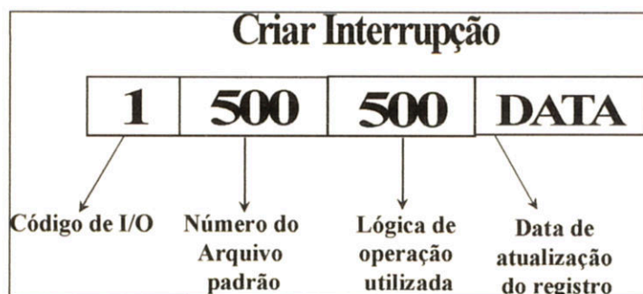
figura 7.5 - Cabeçalho do arquivo padrão tipo 500 com lógica para inserir uma interrupção no FI2
