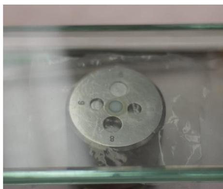
**Figura 13.** Restante de incremento de resina, compactação com plástico filme policloreto de vinila (PVC) e placa de vidro para atingir a espessura uniforme.
