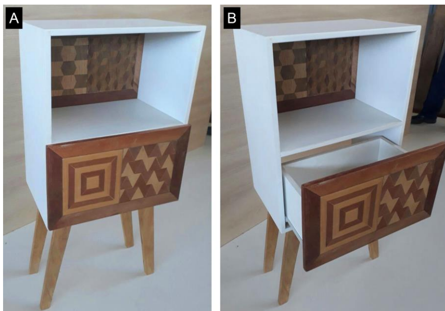
Figura 6: Móvel de apoio finalizado: A) com a gaveta fechada, detalhe da moldura de madeira que dá acabamento aos encaixes dos módulos; B) com a gaveta aberta. Fonte: elaborado pelas autoras.
