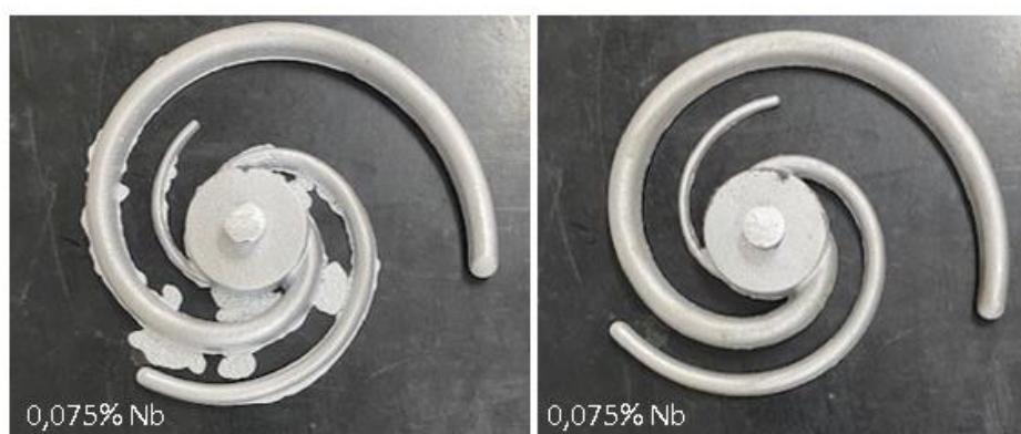
Figura 31. Corpos de prova de fluidez para a liga com adição de 0,075% de nióbio.
