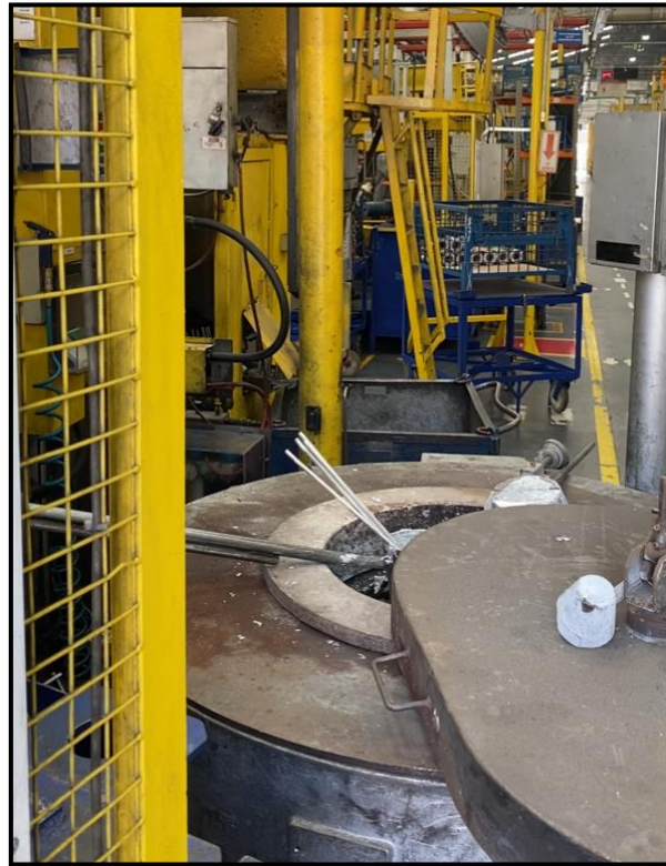
Figura 11. Processo de adição do nióbio na panela de transferência.
