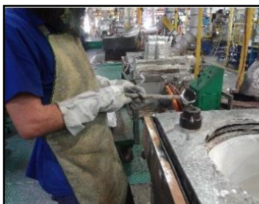
Figura 13. Procedimento para controle de processo e aferição de condutividade elétrica.
