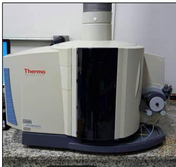
Figura 27. Exemplo de equipamento para avaliação de composição química via espectroscopia de emissão ótica.
