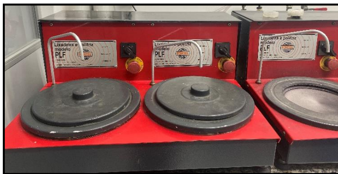
Figura 17. Politriz rotativa para preparação metalográfica modelo PLF do fabricante Fortel.
