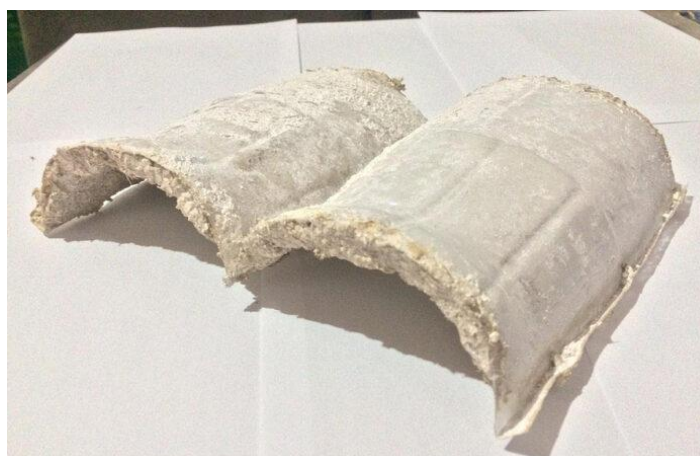
Figura 4 – Telha ecológica de gesso e palha de coco. Fonte: Ciclovivo (2021).
