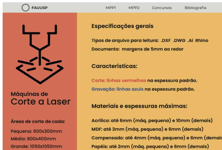
Figura 2: Exemplo de ficha para uso das máquinas de corte a laser. Fonte: elaborado pelos autores.
