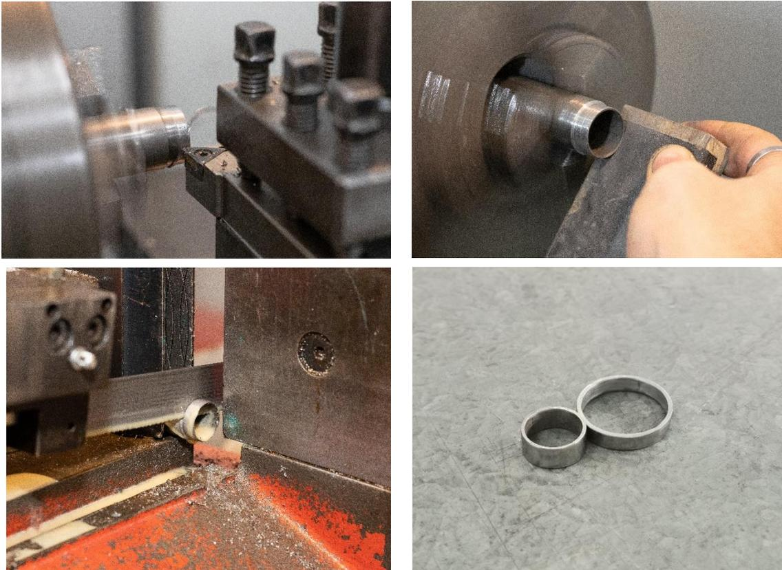
**Figura 9 – Operações de maquinação dos perfis de aço tubulares para a fabricação dos anéis. Em cima à esquerda: torneamento; em cima à direita: retificação; em baixo á esquerda: corte; em baixo á direita: peças maquinadas.**
