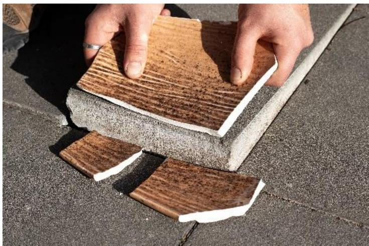
**Figura 5 - Fratura manual do caco.**
