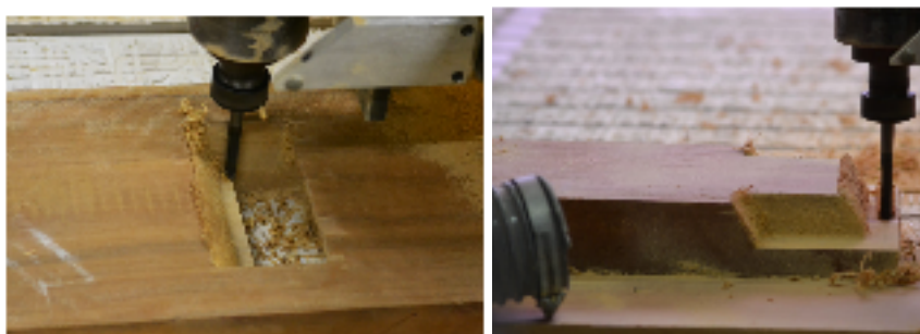
Figura 9 e 10: Usinagem do encaixe fêmea e do encaixe macho. Fonte: elaborado pelos autores.
