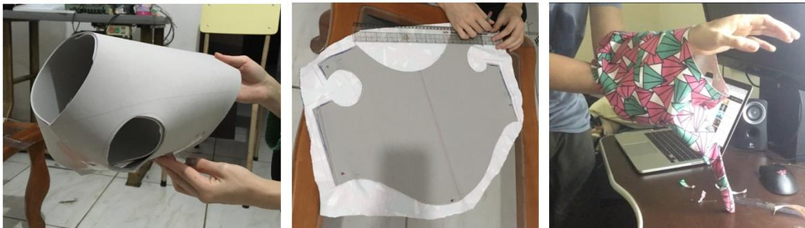
**Figura 8: Desenvolvimento da roupa para fixação da prótese. Fonte: elaborado pelos autores.**
