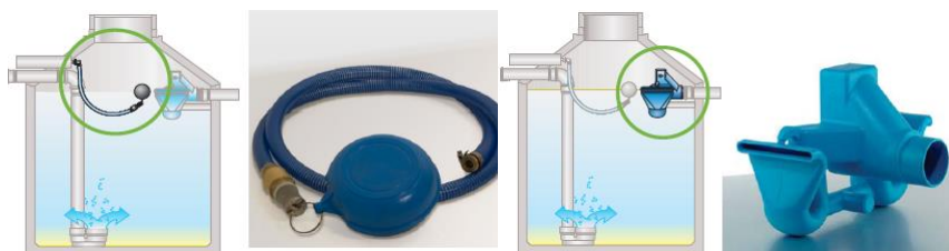
Figura 3: Filtro flutuante de sucção e sifão ladrão. Fonte: (RODRIGUES, 2010; FEAM, 2016)
