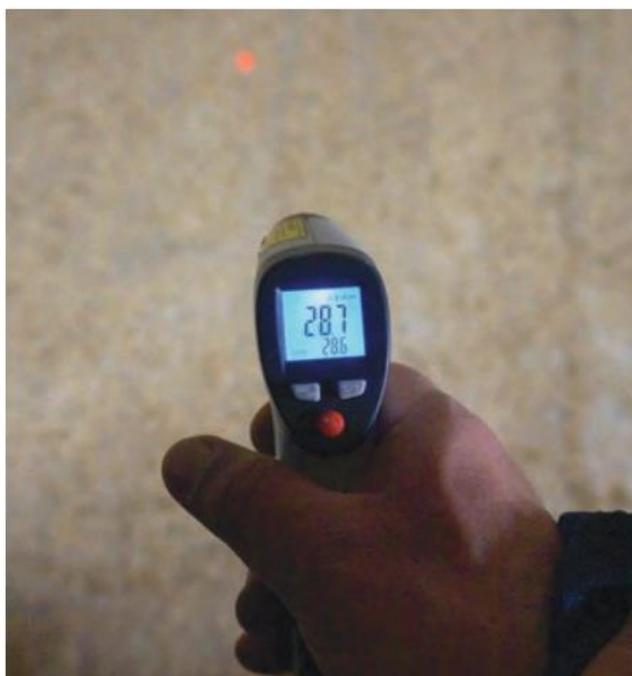
Figura 1: termômetro realizando a medição da temperatura da cama do aviário.
