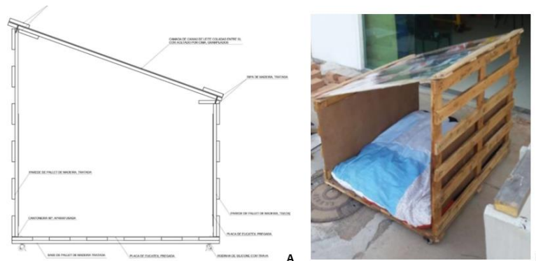
Figura 7: Casa para cachorros de paletes de madeira. (A) Projeto. (B) Protótipo executado. Projeto e execução realizados pelos alunos: Andressa Linhares, Ingrid Coelho, Juliana Ramalho, Lucas Lopes, Nathália Ferreira, Rui Rosa, Sany Santana. Semestre 2018. 1. Fonte: acervo do autor.
